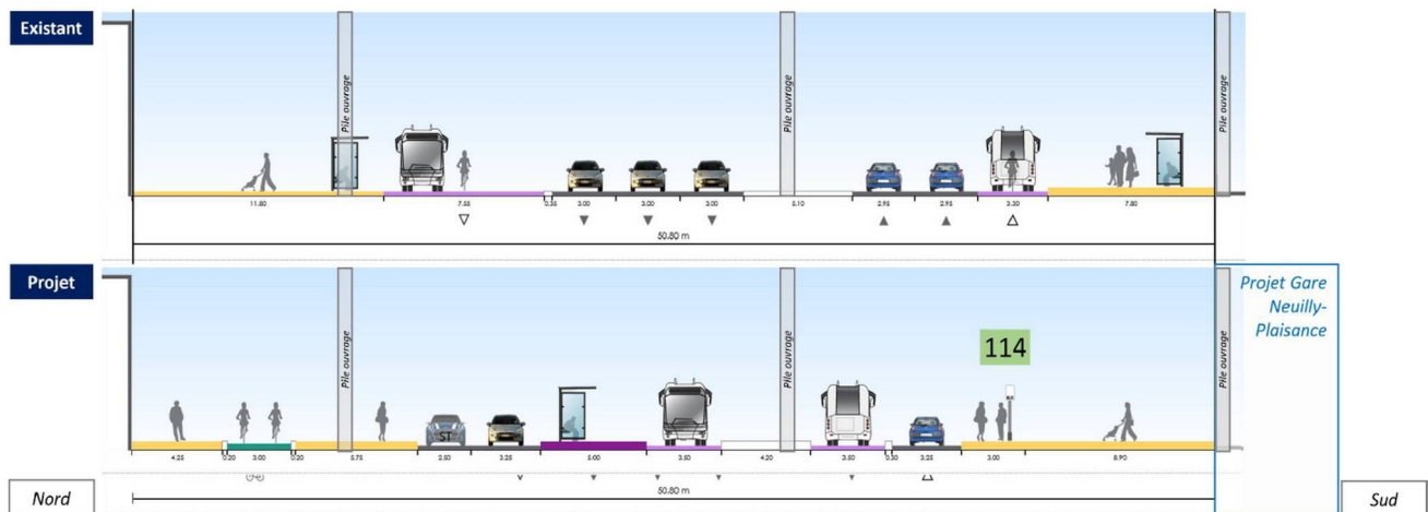
Illustration 13 : Coupe du boulevard Gallieni à Neuilly-Plaisance avant/après projet, source : étude d'impact, F2, p. 67
